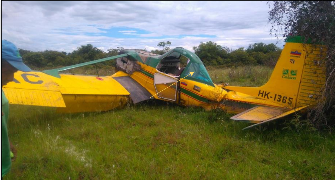
Fotografía No. 1: Deformación estructural fuselaje
