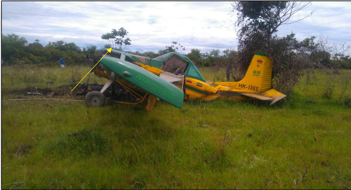
Fotografía No. 2: Desprendimiento del motor a la bancada Nota: Las fotografías fueron obtenidas por parte del explotador
