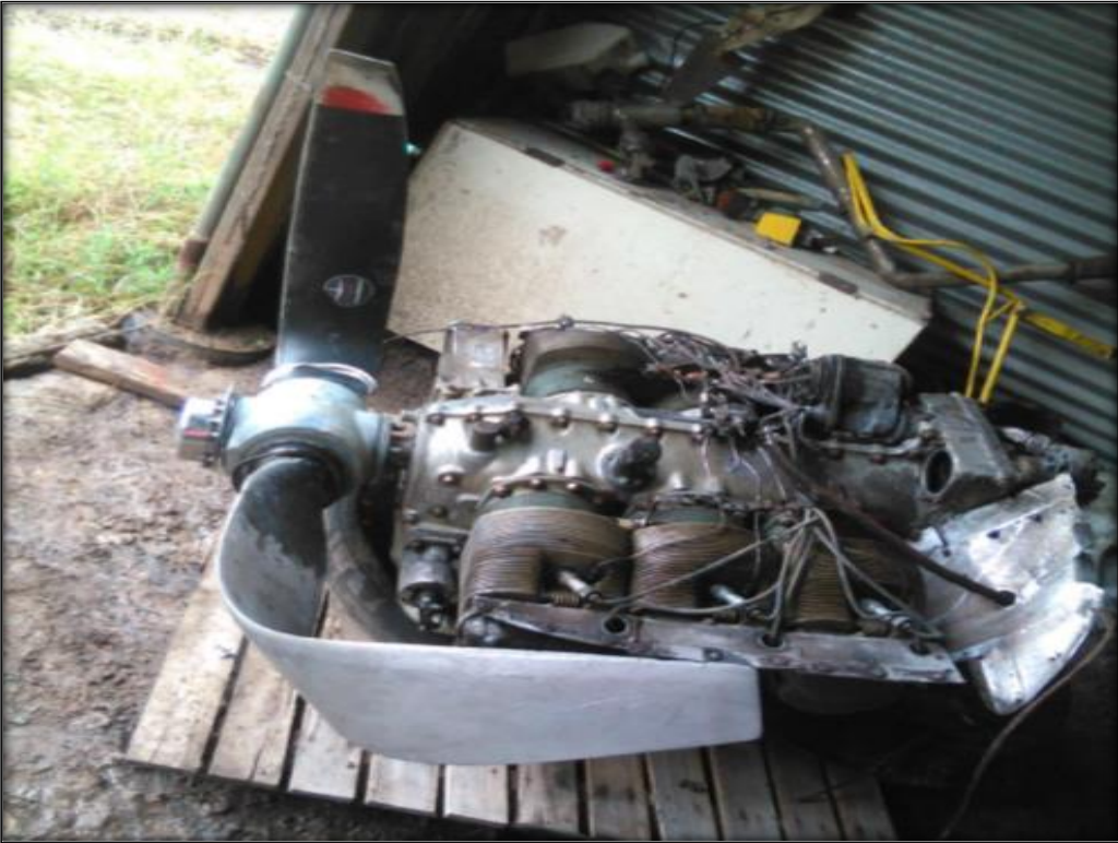
Fotografía No. 2 – Apariencia final del motor y hélice instaladas en la aeronave HK-1365
